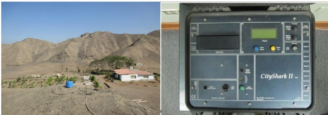
Figura 5: Equipo sísmico utilizado para el registro de vibraciones ambientales en Quilmaná: sensores Lennartz (2N) y registrador CityShark II.
