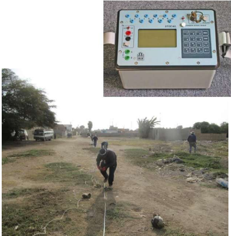
Figura 12: Imagen de disposición del equipo de prospección eléctrica para la toma de datos
