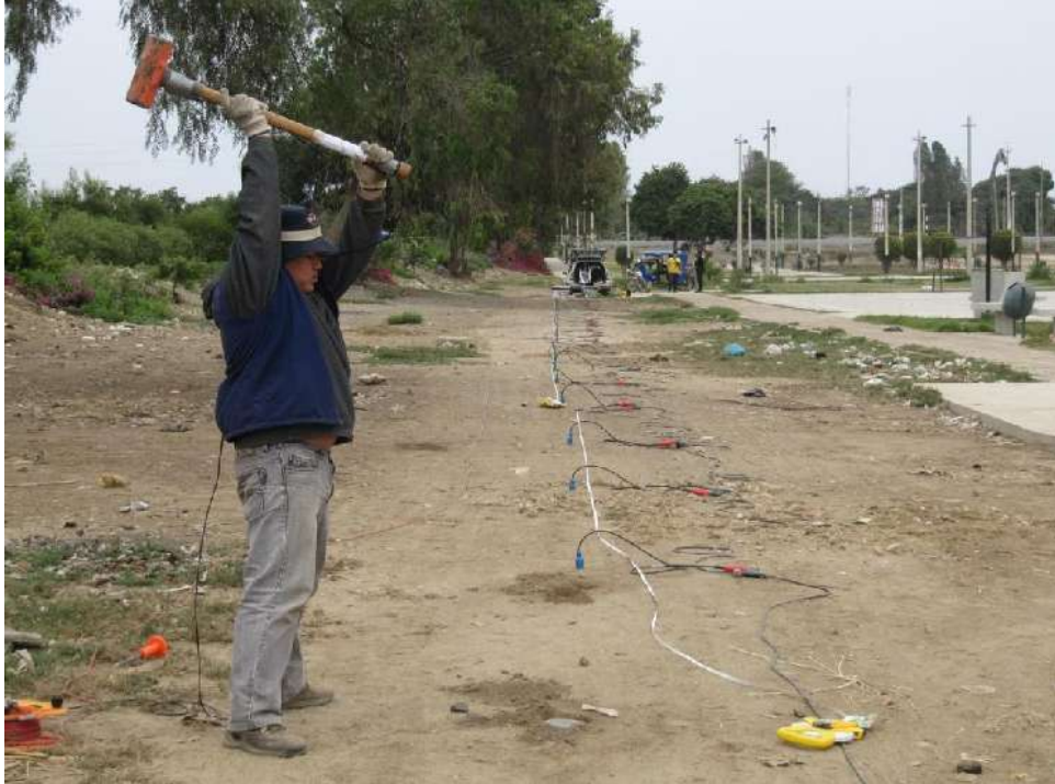
Figura 11: Imagen de la disposición del equipo de refracción sísmica para la toma de datos
